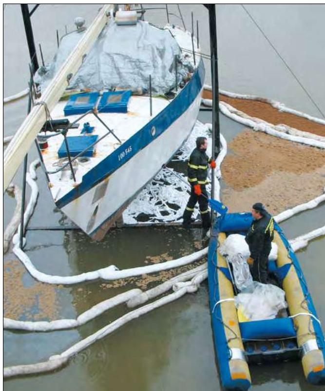
**Las barreras absorbentes pueden ser fabricadas en diferentes longitudes**
